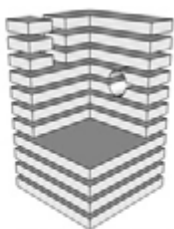
Separación en capas para impresión 3D
