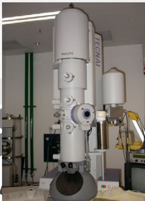
Figura 4. Microscopio Phillips Tecnai F20, especializado para el estudio de las nanoestructuras. (Instalado en el 2003, Instituto de Investigaciones Metalúrgicas-UMSNH).
