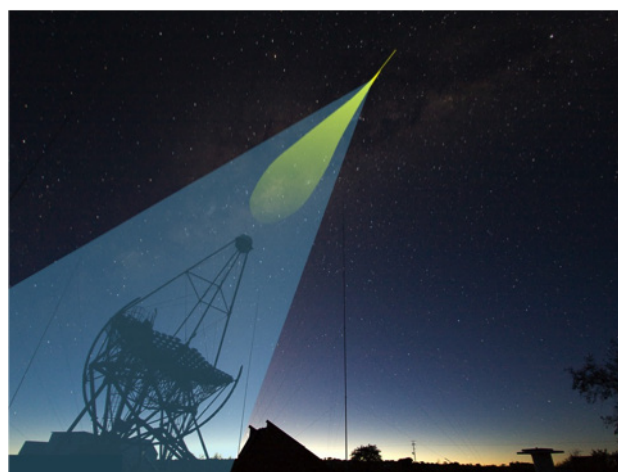
Fig. 2. Los IACT detectan la luz Cherenkov azul emitida en el aire al paso de los chubascos atmosféricos de partículas generados por rayos gamma de alta energía
