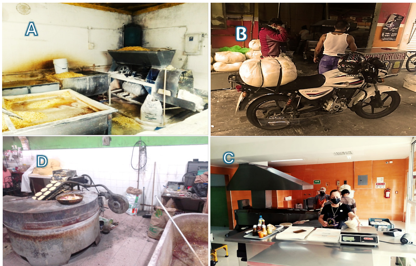
Cadena de transformación de maíz a tortilla: A, Proceso de nixtamalización; B, Transporte de masa en maletas; C, Máquina de tortilla de última generación; D, Máquina de tortilla de primera generación. Elaboración propia.
