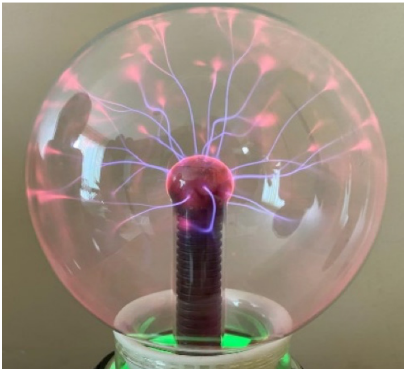
Figura 2. El plasma. Se puede confinar un gas en una esfera, en donde se instala un dispositivo capaz de generar carga. El gas se ioniza y se manifiesta como un plasma, los pequeños rayos de color morado que al descargar en la superficie interna de la esfera se ve color naranja.
