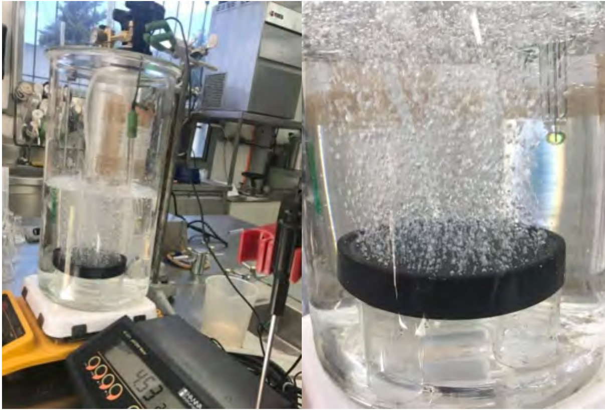
Fig. 3. Sistema montado del biorreactor para calcular el coeficiente K_La (Hernández-Ixta).
